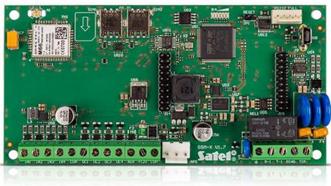
Устройство может полностью заменить аналоговую телефонную линию, действуя как запасной канал связи. Если линия недоступна, то модуль передает голосовые звонки сотовой сети. В случае мини-АТС модуль может выполнять функцию дополнительной внешней линии.
